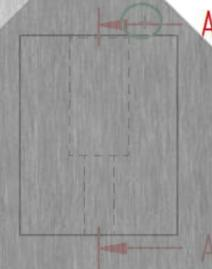
... und „schiebst“ den Schnitt als Vorderansicht nach links, oberhalb der Draufsicht → Mausclick! Die geschnittene Fläche, also wo „Material“ durchgeschnitten wurde, erscheint als schraffierte Fläche (45°). Nun kannst du die Ansichten und die Bohrungen bemaßen.
