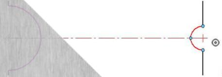
... und schließt mit einem Mausklick ab. Da die beiden Rinnen als Halbkreise dargestellt werden, müssen sie noch durch deren Mittelpunkt mit einer Symmetrieachse gekennzeichnet werden.
